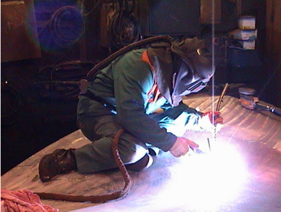
Kuva 247. Teräsvalukappaletta korjaushitsataan Tig-menetelmällä
