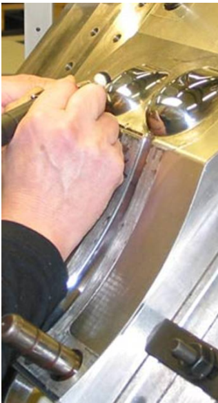
Kuva 6. Muotin kiillotusta käsityökalulla. Kuvaassa sähkö ja paineilmakäyttöisiä laitteita
