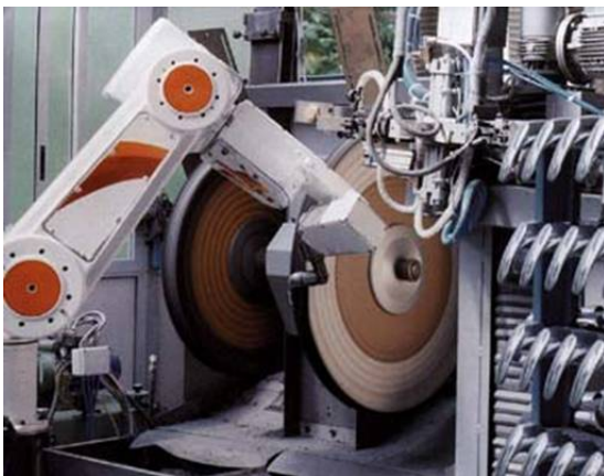
Kuva 9. Automatisoitu kiillotus robotilla. Robotti vie työkappaleen pyörivä laikkaa vasten.
