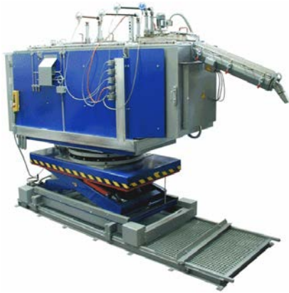
Kuva 5. Eräs kylmäkammiopainevalukoneelle sopiva annostelu-uuni. Rauch Fertigungstechnik, http://www.rauch-ft.com .
