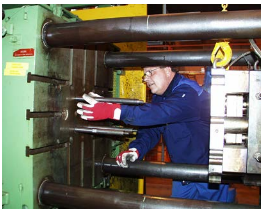
Kuva 12. Painevalukoneen ulostyöntöyksikkö kiinnitetään muotin ulostyöntömekanismiin neljällä ulostyöntötangolla. Tangot kulkevat liikkuvan muottipöydän läpi väljissä rei'issä. Reikien paikat on merkitty valukoneen pöytäkuviin. Ulostyöntötankojen päissä on kiertet molemmissa päissä. Koneen puoleinen pää kiinnitetään mutterilla ja toinen pää kierretään suoraan muotin ulostyöntölaattoihin kiinni. Uusissa painevalukoneissa on erilaisia pikakiinnitysmekanismeja.
