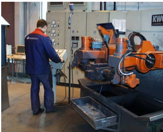
Kuva 3. Karusellityyppisen matalapainevalukoneen runkorakennetta sekä koneeseen kiinnitetty muotti. Runkorakenne poikkeaa edellä esitetystä. Muotti avautuu yhdeltä jakopinnalta, kuten tavanomaisessa johteisiin perustuvassa ratkaisussa. Karusellityyppiset kokillivalukoneet ovat samantapaisia.
