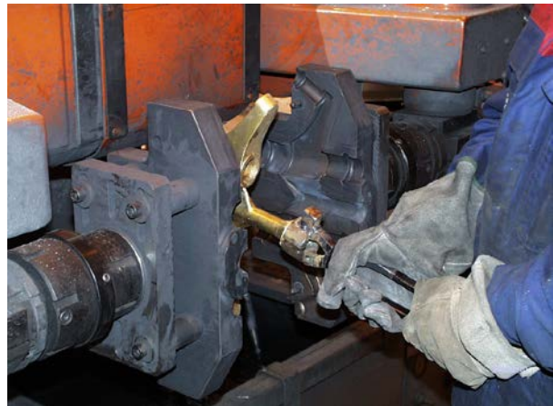
Kuva 3. Karusellityyppisen matalapainevalukoneen runkorakennetta sekä koneeseen kiinnitetty muotti. Runkorakenne poikkeaa edellä esitetystä. Muotti avautuu yhdeltä jakopinnalta, kuten tavanomaisessa johteisiin perustuvassa ratkaisussa. Karusellityyppiset kokillivalukoneet ovat samantapaisia.
