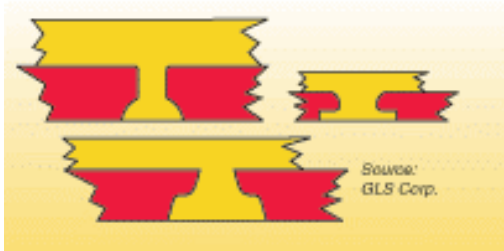
Kuva 4. Mekaanisia lukitusmuotoja, jotka parantavat materiaalien liittymistä toisiinsa.
