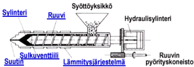
Kuva 6. Vasemmalla: Kaaviokuva ruiskutusyksiköstä. Oikealla: Ruiskutusyksikkö.
