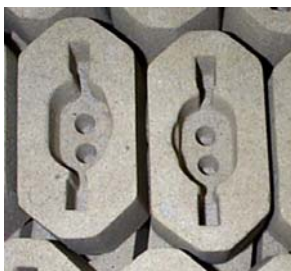
Kuva: Näytteiden ottaminen. Ylhäällä vasemmalla: Sulanäytettä tuodaan valulinjalta. Alhaalla vasemmalla on esitetty näytekappaleen hiekkamuotti mikrorakennetarkastusta varten. Ylhäällä oikealla tapahtuu näytteiden valaminen.
