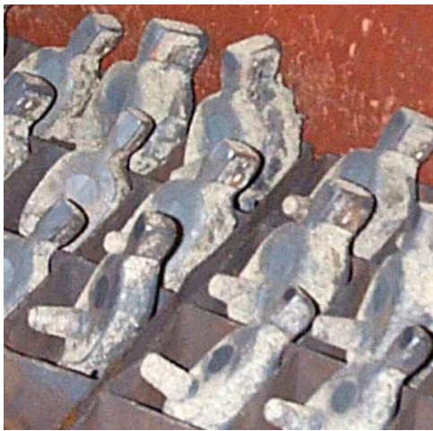
Kuva: Näytteiden ottaminen. Vasemmalla ylhäällä: Kuvassa vasemmalla on analysointinäytteen kokillimuotti ja oikealla mikrorakennenäytteen hiekkamuotti. Oikealla ylhäällä: Vastavaaletut näytteet. Vasemmalla alhaalla: Systemaattisesti otetut näytteet tutkitaan ja varastoidaan.
