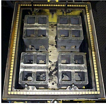
Kuva: Mallipaletti, mallilevyt ja mallit. Ensimmäisessä kuvassa on esitetty mallipaletti, johon malli mallilevyineen (oikealla) kiinnitetään.
