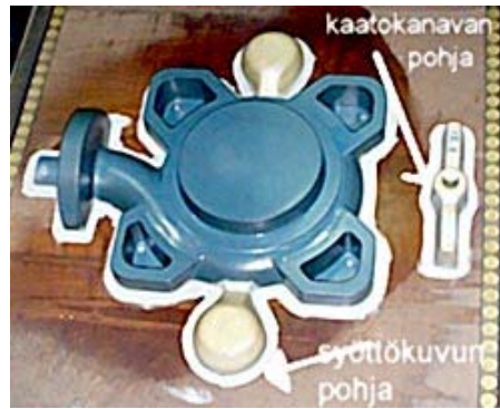
Kuva: Mallipaletti, mallilevyt ja mallit. Muotin valmistuksessa tarvittavat mallin puolikkaat kiinnitettyinä mallilevyihin ja -paletteihin. Vasemmalla olevassa kuvassa näkyvät muottihiekan sisään jäävät eristävät syöttökuvut (4kpl).
