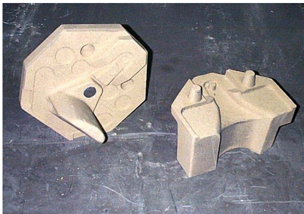
Kuva: Mallin avulla tehtäviin muottipuoliskoisiin tulevat keernat.
