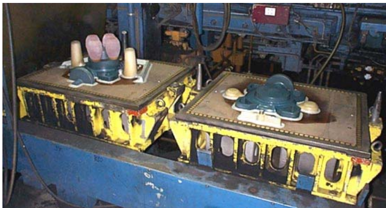
Kuva: Mallit odottavat automaattikaavauslinjan kaavauskoneeseen siirtämistä.
