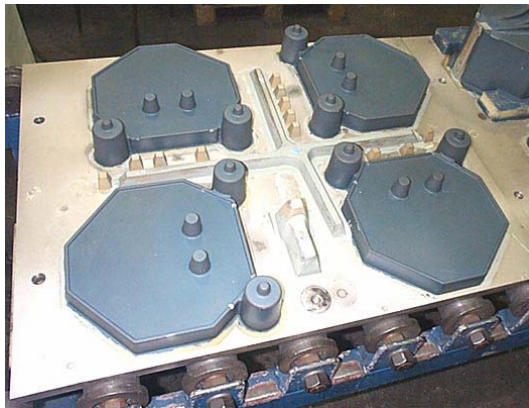
Kuva: Vasemmalla: Mallin puolikkaat kiinnitettyinä mallilaattoihin. Oikealla: Mallin puolikkaat kiinnitettyinä mallilaattoihin.
