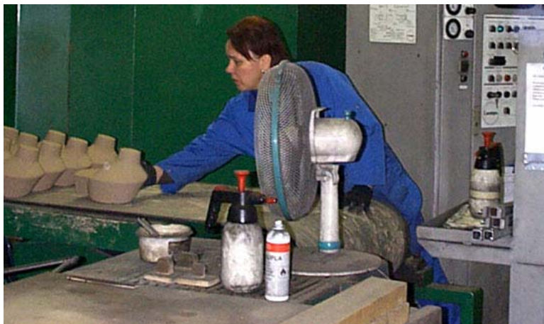
Kuva: Lopuksi keerna laitetaan hihnalle, joka kuljettaa sen peitostettavaksi.
