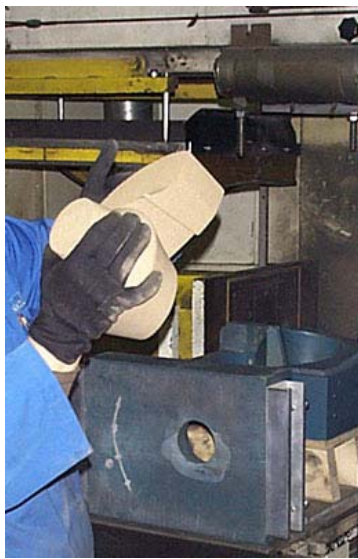
Kuva: Keerna nostetaan käsin keernatykistä ja siitä poistetaan jakopintapurseita (oikealla).
