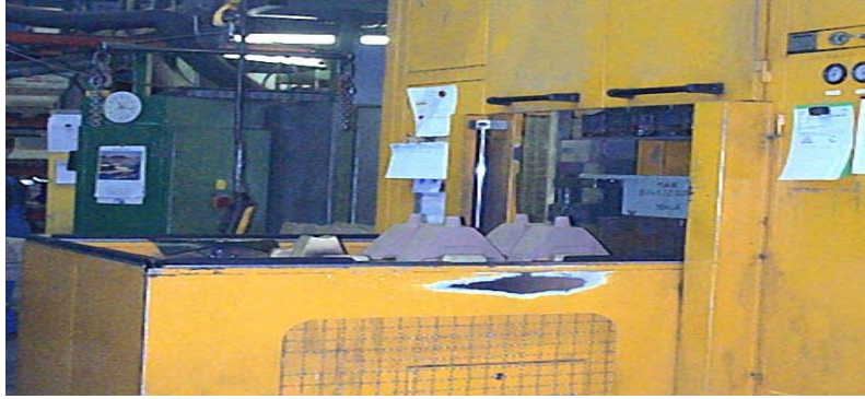
Kuva: "Uunituoret" keernat odottavat koneesta pois nostamista. Tämän jälkeen keernat menevät peitostettaviksi.
