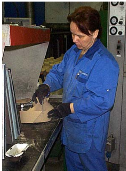
Kuva: Keerna nostetaan käsin keernatykistä ja siitä poistetaan jakopintapurseita (oikealla).
