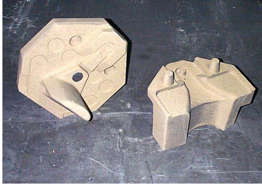
Kuva: Edellisen kuvan laatikolla valmistetut keernat. Yhdellä keernalaatikolla valmistetaan kaksi kappaletta keernoja.
