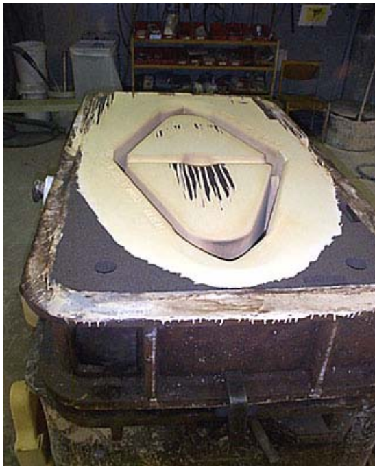
Kuva: Peitostamaton ja peitostettu muotti sekä valutuspeitostuksen suoritus.
