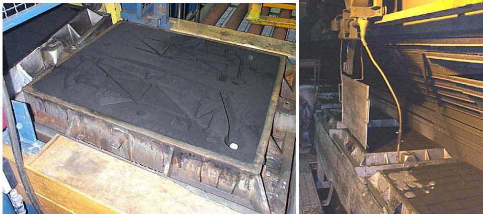
Kuva: Vasemmassa kuvassa on muottiympäysnappi, joka on laitettu kaatokanavan pohjan kohdalle. Oikea kuva esittää elvytysympäykseen käytettyä ympäysjauhetta valusuihkuun ohjaavaa suutinta. Kuva on otettu kaadon jälkeen.
