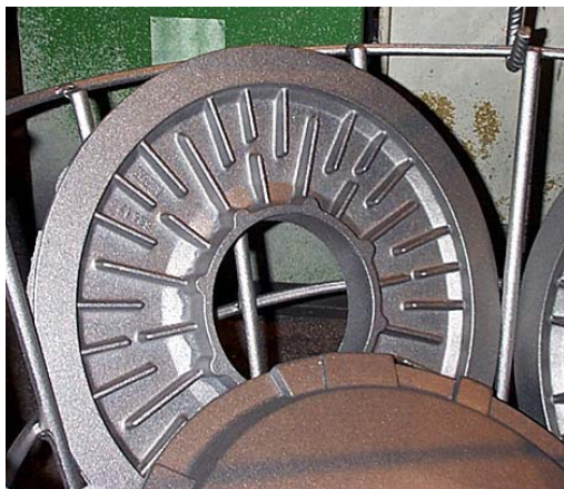
Kuva: Vasemmalla: Valukappale sinkopuhdistettuna. Oikealla: Valukappaleita tulossa sinkouksesta (Kuvan taustalla näkyvä kone).
