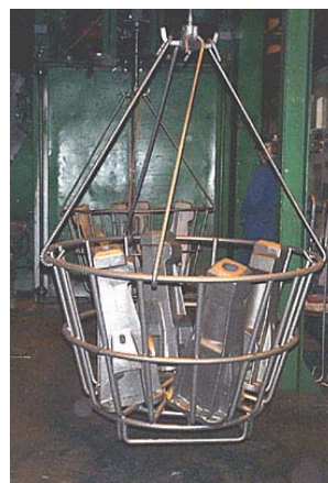
Kuva: Vasemmalla: Valukappale sinkopuhdistettuna. Oikealla: Valukappaleita tulossa sinkouksesta (Kuvan taustalla näkyvä kone).
