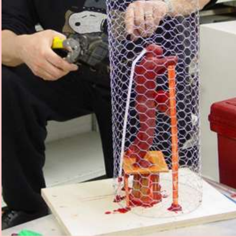
Muotin tukirakenteen tekeminen
