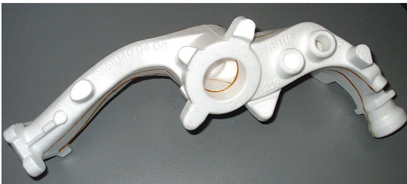
Kuva 9. Polystyreenimalli. Malli on liimattu kokoon useammasta osasta. Vaikka kappaleessa on usean suuntaisia reikiä ja ulokkeita, EPS-muotit eivät välttämättä ole monimutkaisia.
