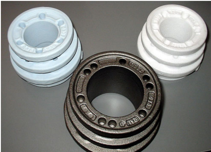
Kuva 8. Oikealla yläkulmassa polystyreenimalli ja vasemmassa yläkulmassa peitostettu polystyreenimalli. Kuvan keskellä täysmuottikaavauksella valettu kappale.
