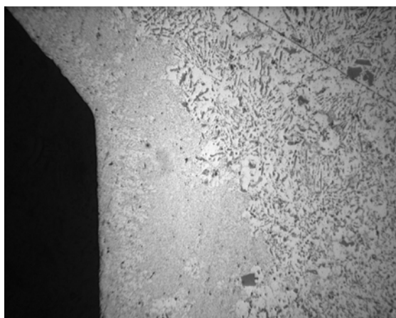
Kuva 6 Poikkileikkaus painevalukappaleen seinämästä. Poikkileikkauksessa näkyy vasemmalla valunahka ja sen oikealla puolella eri tavalla kiteytynyt seinämän sisäosa. Matti Niemi, Tampereen teknillinen yliopisto.
