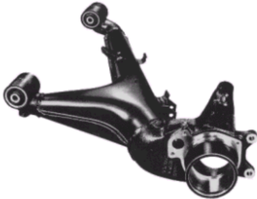
Kuva 20. Kolmesta tempervaluosasta ja kahdesta teräslevyosasta valmistettu henkilöauton takapyörän ripustus.
