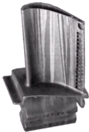
Kuva 22. Suunnatun jähmettymisen avulla superseostarkkuusvaluna valmistettu virumiskestävyydeltään optimoitu suihkumoottorin turpiininsiipi.
