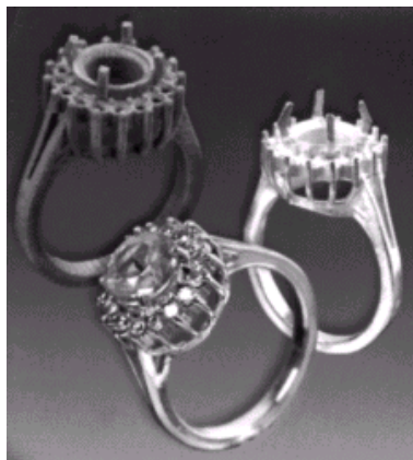
Kuva 16. Pikamalli (vas.) ja sen avulla tarkkuusvalettu sormuksen runko (oik.) sekä valmis sormus kivineen (alin kpl).
