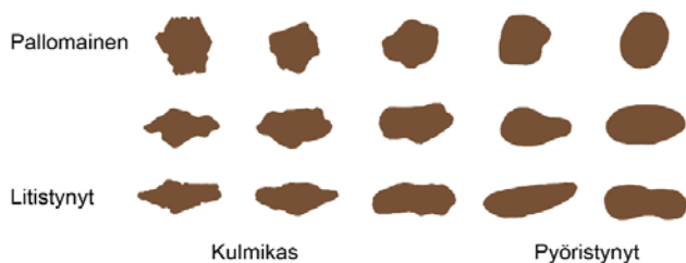
Kuva 3. Hiekkarakeiden raemuodot kuvattuna akseleilla kulmikas – pyöristynyt sekä pallomainen – litistynyt. Kuvan lähde: Woudloper (Oma teos) [Public domain], Wikimedia Commons.
