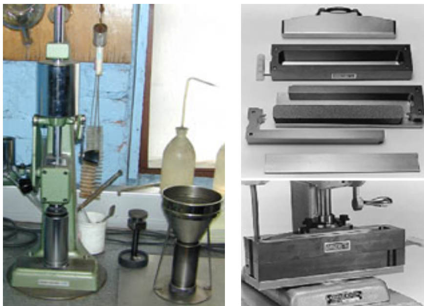
Kuva 10. Vasemmanpuoleisella laitteella tehdään sylinterinmuotoisia koekappaleita mm. puristuslujuusmittauksiin ja oikeanpuoleisella laitteella tehdään koekappaleita taivutuslujuuskokeisiin. Oikeanpuoleisen kuvan lähde: "Ridsdale & Co. Ltd" http://www.basrid.co.uk .
