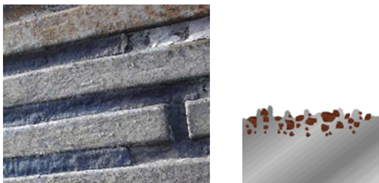
Kuva 4. Hiekan pureutuminen kiinni valukappaleeseen.
