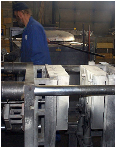
Kuva 3. Vasemmalla: Avattu kokillivalumuotti. Oikealla: Valu manuaalisesti kauhomalla.
