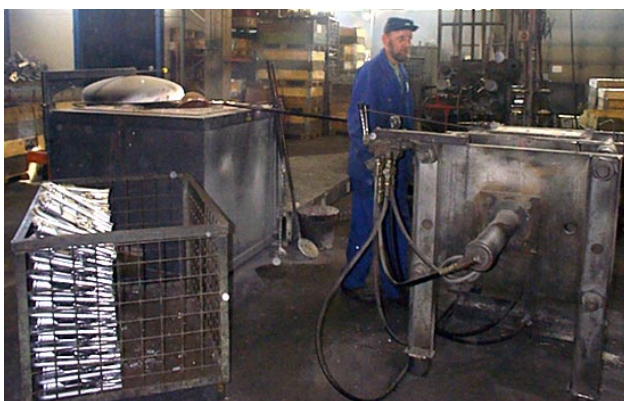
Kuva 1. Kokillivalupiste, jossa vasemmalla kuumanapitouuni ja oikealla pneumaattisesti toimiva kokillivalukone.
