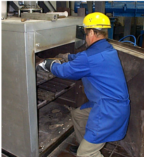
Kuva 4. Vasemmalla. Hiekasäiliö mallilaatan päällä. Oikealla: Hiekalla peitetty mallilaatta siirretään paistettavaksi.
