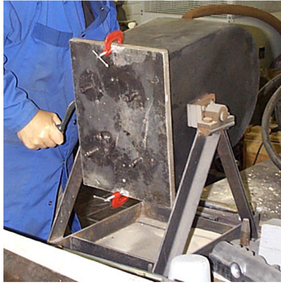
Kuva 3. Vasemmalla: Valmis kuorimuotti, joka on vielä mallilaatassa kiinni. Oikealla: Hiekasäiliötä käännetään mallilaatan päälle.
