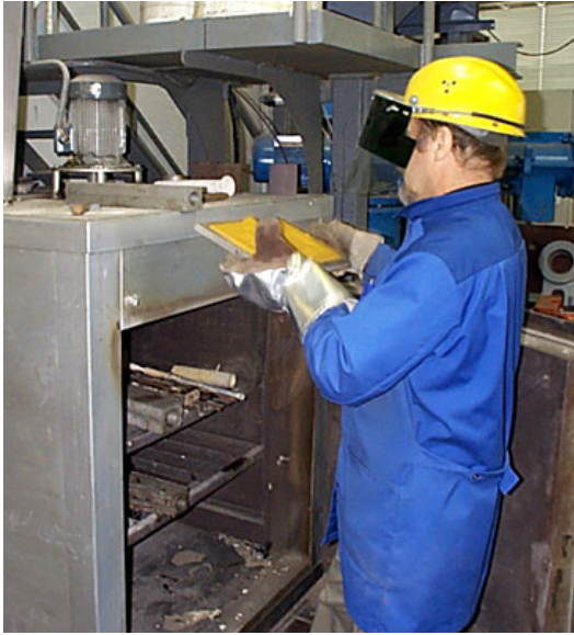
Kuva 3. Vasemmalla: Valmis kuorimuotti, joka on vielä mallilaatassa kiinni. Oikealla: Hiekasäiliötä käännetään mallilaatan päälle.
