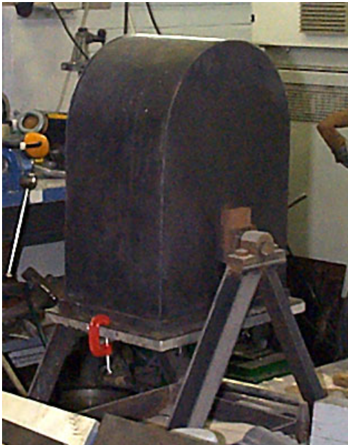
Kuva 4. Vasemmalla. Hiekasäiliö mallilaatan päällä. Oikealla: Hiekalla peitetty mallilaatta siirretään paistettavaksi.
