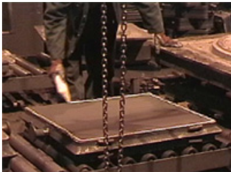
Kuva 2. Muotin jakopinnan tiivistys pursotettavalla tahnalla.
