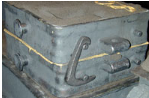
Kuva 2. Muotin jakopinnan tiivistys pursotettavalla tahnalla.
