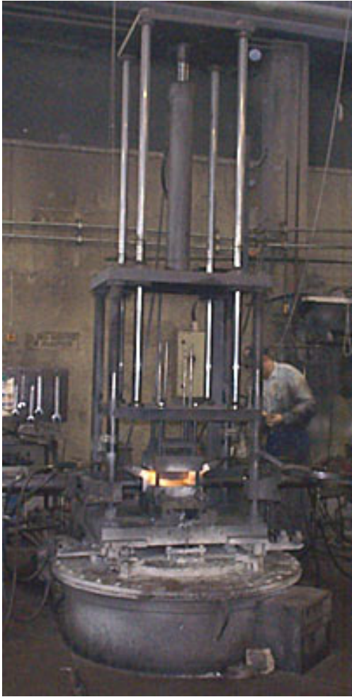
Kuva 3. Vasemmalla: Matalapainevalulaitteisto, jossa muotti avautuu vaaka-asennossa olevalta jakotasolta. Oikealla: Muotti esikuumennusvaiheessa.
