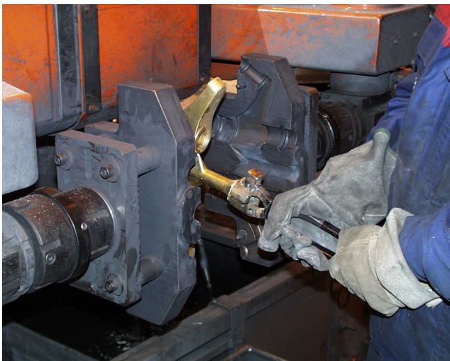
Kuva 7. Karusellityyppisen matalapainevalukoneen muottipöydät ja muotti.
