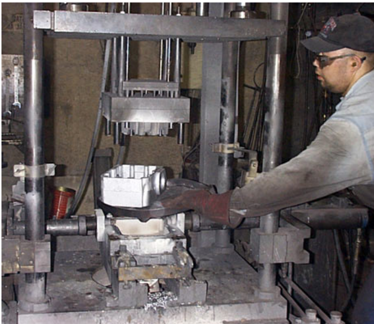
Kuva 6. Valmiin valukappaleen pudotus alustalle.
