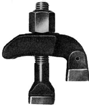
Kuva 5. Kiinnitys- eli festirauta, jolla muotti kiinnitetään valukoneen muottipöytiin.
