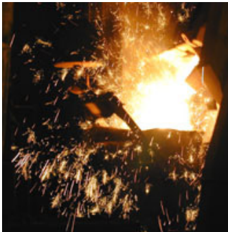
Kuva 2. Ylhäällä vasemmalla: Sulankäsittelyä senkassa. Ylhäällä oikealla: Sulaton työvaatetus.
