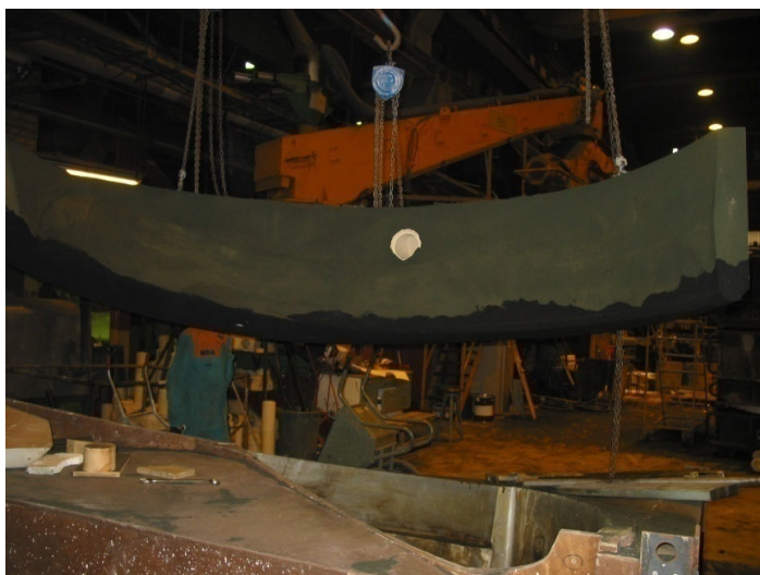
Kuva. Kromiittihiekkaa (musta hiekka) käytetty keernan kohdassa, jossa kiinnipureutumisriski kvartsihiekkalla olisi suuri
