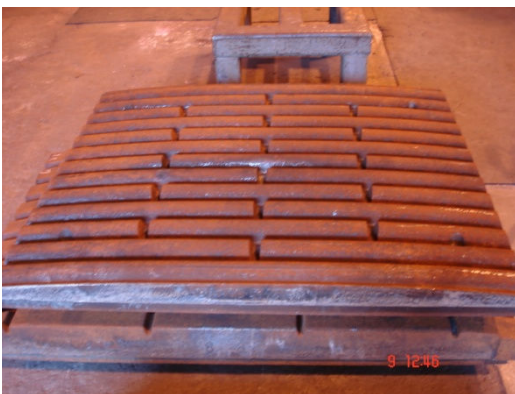
Kuva. Mangaaniteräksestä valettu kivenmurskaimen leuka
