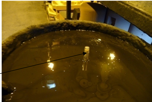
Kuva. Grafiittipohjaisen spriipeitosteet ominaispainoa mitataan Baume-mittarilla
