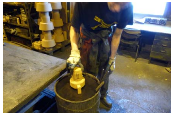
Kuva. Keerna upotuspeitostetaan
