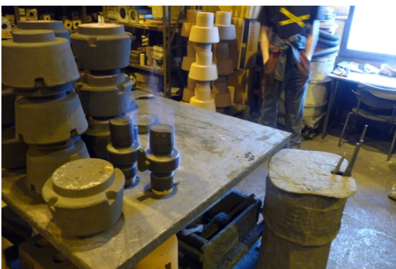
Kuva. Spriiukoinen peitoste poltetaan
