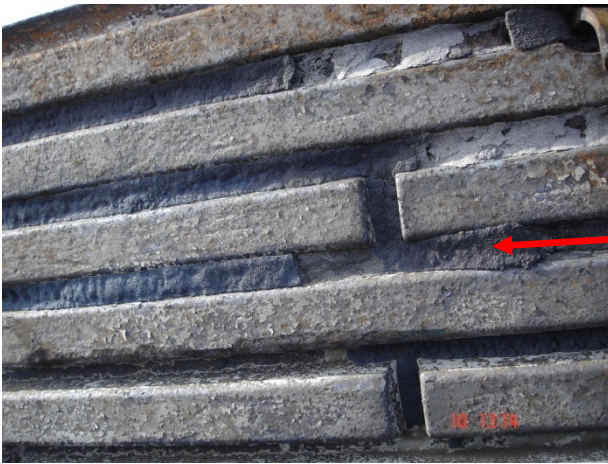
Kuva. Hiekka kiinnipalanut eli pureutunut valukappaleeseen
