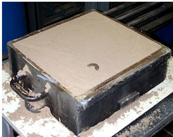
Kuva 5. Täytetty muotin ensimmäinen puolisko (tehty yläpuoli ensin)
