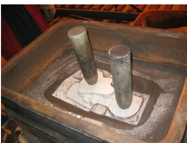
Kuva 23. Kehä ja kanavat paikallaan
