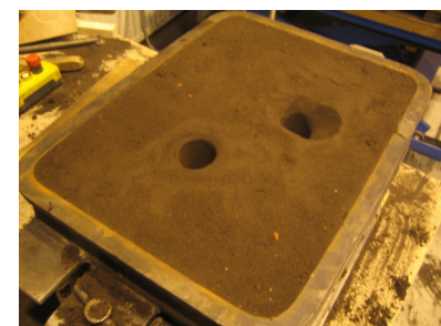
Kuva 25. Kanavat irrotettu ja muotin pinta viimeistelty
