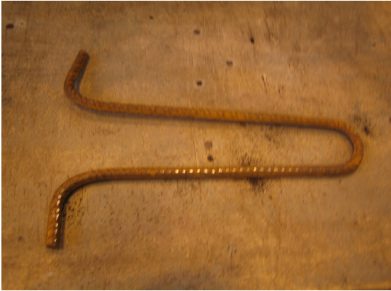
Kuva 61. Tukirauta tai nostolenkki väännetty muotoon, joka estää sen irtoamisen keernasta
