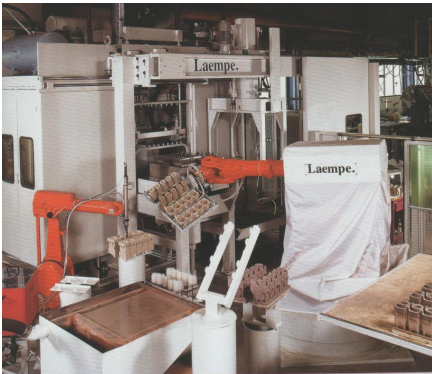
Kuva 116. Keernan peitostusta robotilla
