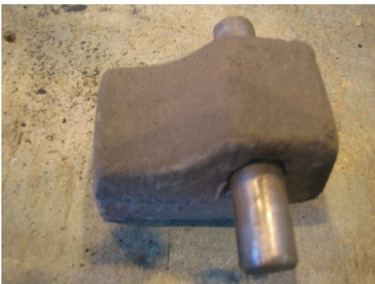
Kuva 85. Keernaan sijoitettu, valukappaleeseen liitettävä osa
