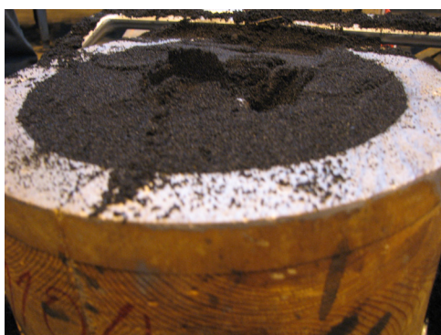
Kuva 77. Nostolenkki on keernan pinnan alapuolella
