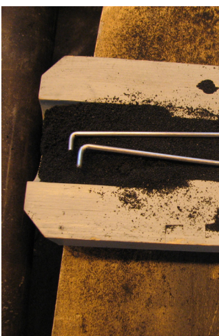
Kuva 67. Keernan tukiraudat taivutettu paikallaan pysymisen parantamiseksi
