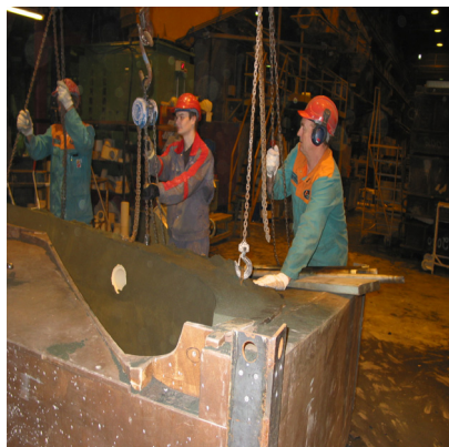
Kuva 104. Keernan nostoa varten ajetaan nostin oikealle kohdalle (nosto kahdella nostimella samanaikaisesti)
