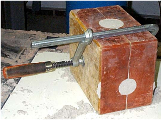
Kuva 39. Keernalaatikko sullottu täyteen
