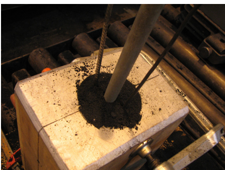
Kuva 71. Tukirautoja ja kaasunpoistokanava asetetaan
