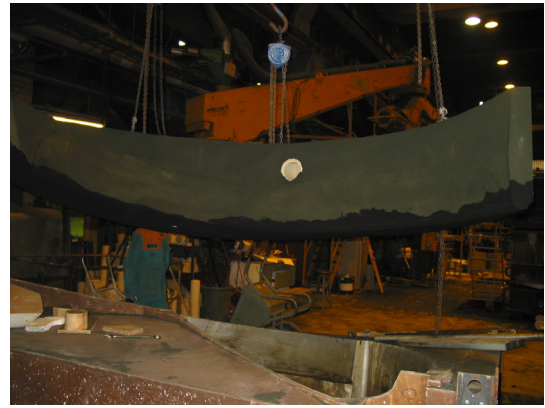
Kuva 107. Keerna on irti laatikosta
