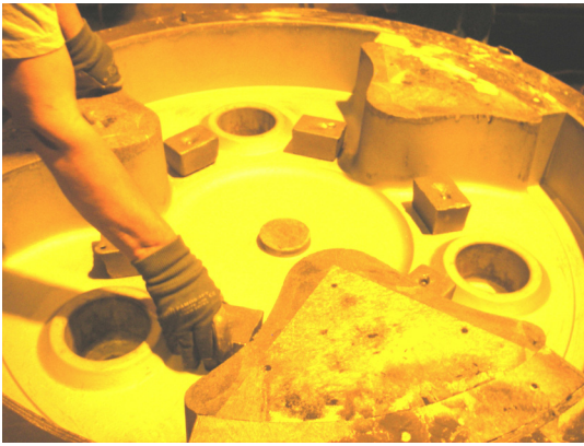
Kuva 83. Jäähdytysrautoja asennetaan keernalaatikkoon
