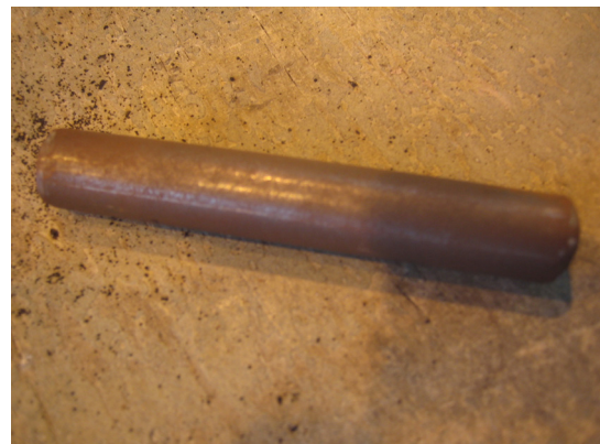
Kuva 86. Liitettävä ruosteinen osa valussa puhdistettava
