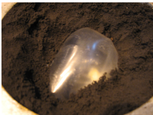
Kuva 94. Muovinen kevennös asetettu keernaan sullontavaiheessa
