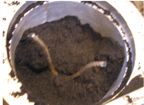
Kuva 73. Nostolenkki sijoitetaan keernalaatikkoon
