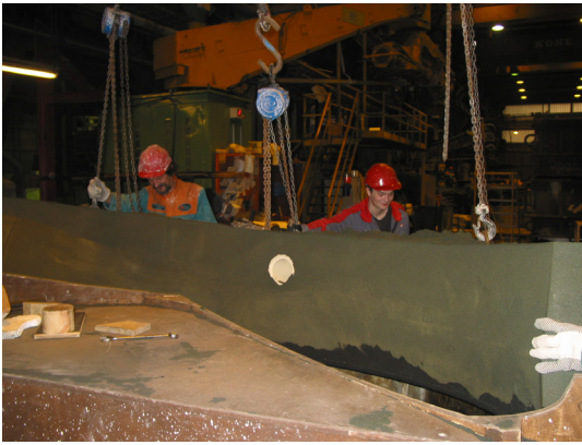
Kuva 106. Keerna on irronnut laatikosta
