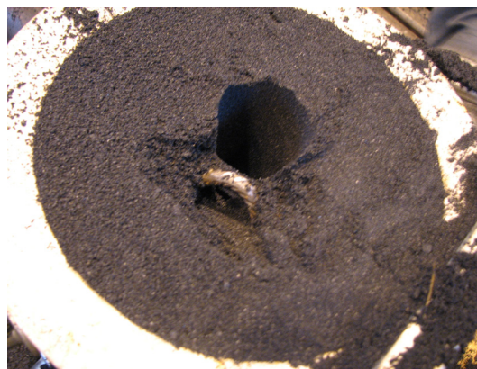
Kuva 76. Kaasunpoistokanavan malli poistettu keernasta
