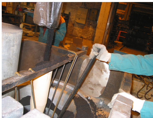
Kuva 93. Muottia sullottaessa nähdään sullottavaan kohtaan
