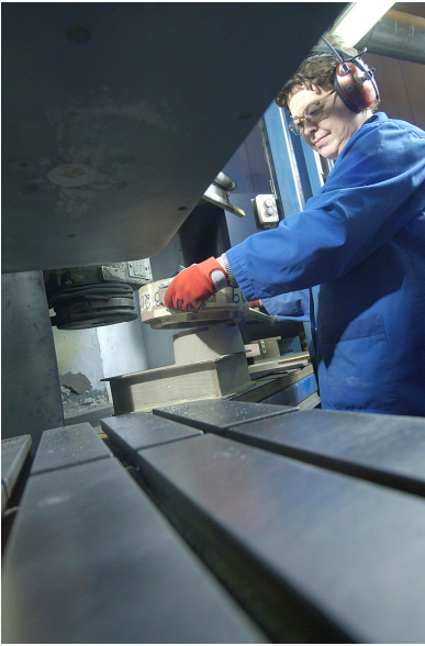
Kuva 113. Keerna poistetaan keernatykiltä
