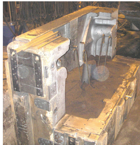
Kuva 53. Keernan täytön yhteydessä sisään asetetaan tuki-, nosto- ja kaasunpoisto-rakenteita
