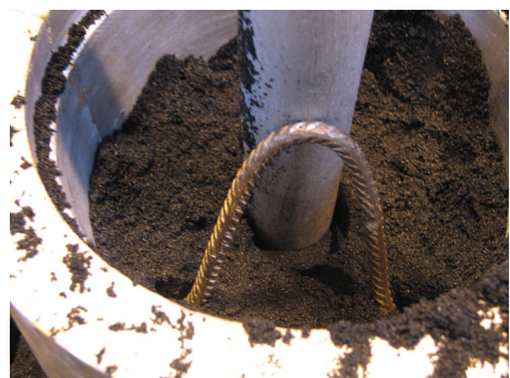
Kuva 74. Nostolenkki on sijoitettu kaasunpoistokanavan yhteyteen
