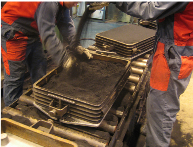
Kuva 120. Muotinpuoliskoa sullotaan ja täytetään
