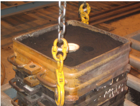
Kuva 141. Kehän nosto kahdella ketjulla, mahdollisuus nostoon neljälläkin
