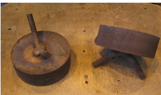
Kuva 176. Jäähditysrautoihin hitsattu tartunta (huom! rautojen pinta ruosteine, puhdistettava esim. sinkopuhalluksella)
