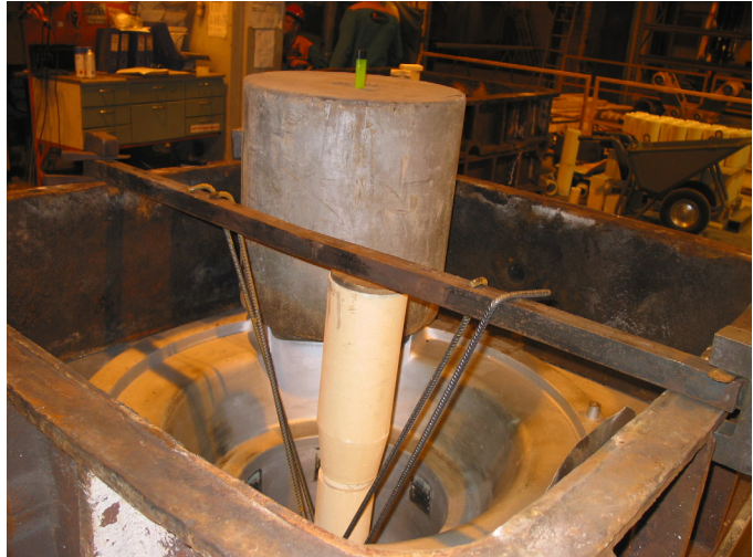
Kuva 182. Kehä varustettu ja valmisteltu kaavausta varten irtosloovarilla
