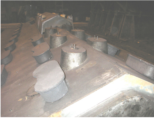
Kuva 161. Jäähdytysraudat asetettu mallin päälle kaavausta varten
