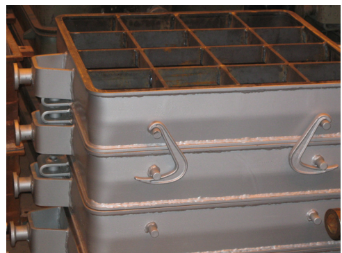
Kuva 138. Kaavauskehän kiinnityskorvakkeissa ramput ja nostokorvakkeet
