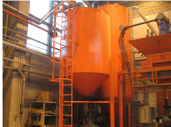
Kuva 203. Varastosilo, johon hiekka voidaan siirtää helposti ulkoa autosta, sekä siihen yhteydessä mixerin päiväsiilo
