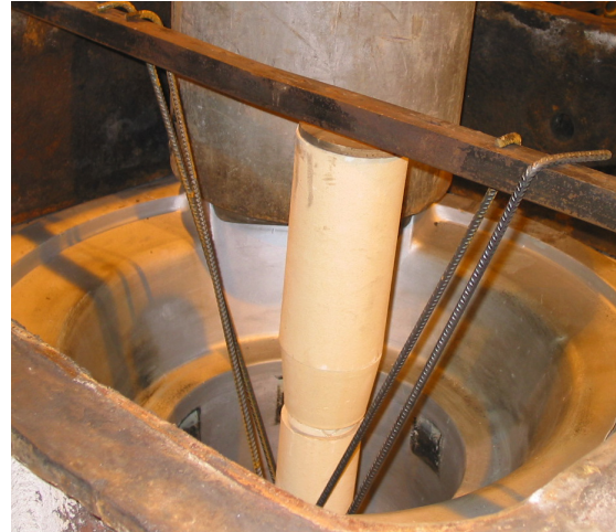
Kuva 184. Malliin sijoitettu hiekkakoukkuja täyttöä varten
