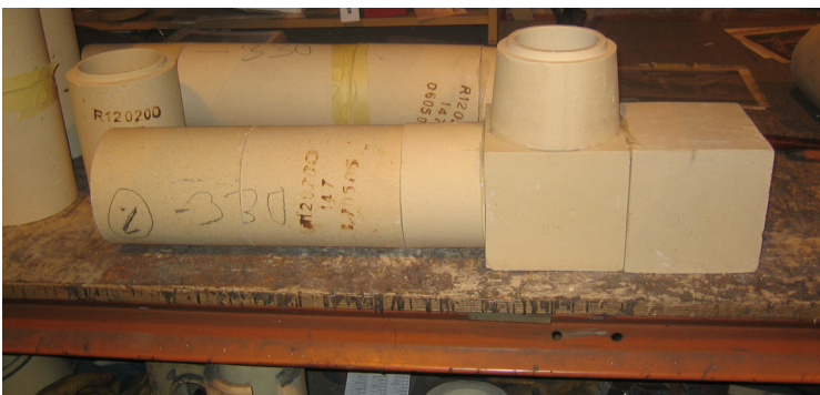
Kuva 185. Valmiiksi rakennettu kanavistopaketti
