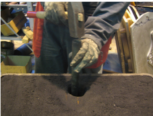
Kuva 255. Mallia irrotetaan kanavistoaukosta
