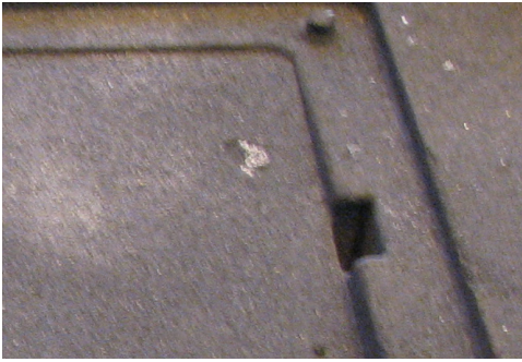
Kuva 259. Muotin pinnassa valuroiske
