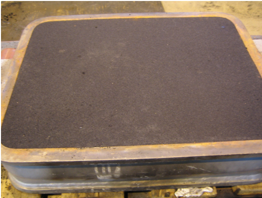
Kuva 265. Pinta korjattu halutun muotoiseksi
