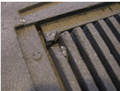
Kuva 258. Muotista rikkoutunut palanen
