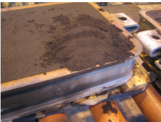
Kuva 263. Kuoppa täytetään hiekalla
