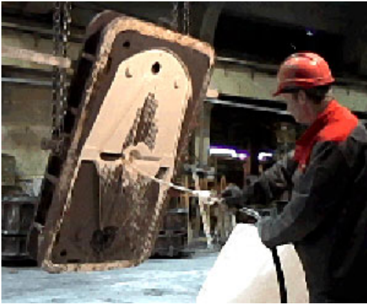
Kuva 282. Valutuspeitostusta suoritetaan sopivalla peitostuspaineella
