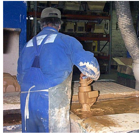
Kuva 285. Keerna nostetaan peitosteesta
