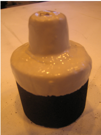
Kuva 275. Liian vahva peitostekerros kastopeitostuksessa
