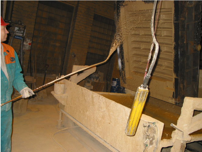
Kuva 273. Valutuspeitostus magnesiittipeitosteella mangaaniteräsvalulle
