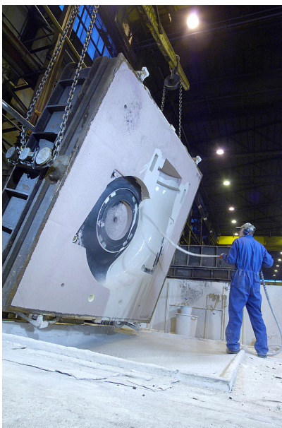
Kuva 272. Muotinpuolisko peitostetaan valutusmenetelmällä
