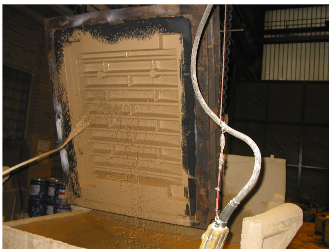
Kuva 288. Peitoste valuu peitostettavalla pinnalla
