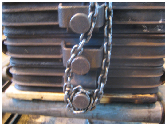
Kuva 327. Nostoketju asetettu ja silmukka tehty
