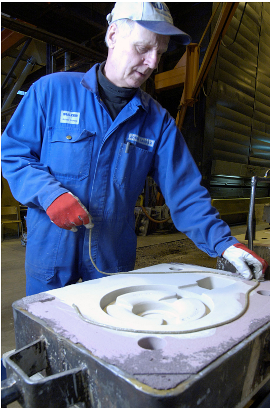
Kuva 336. Tiivistenuuha asetetaan jakopinnalle
