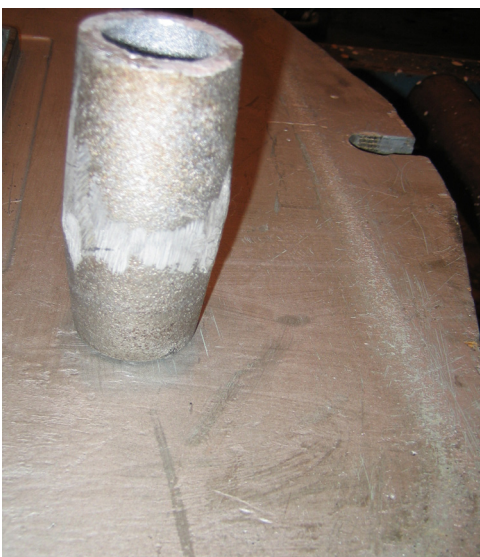
Kuva 352. Alumiininen jakotason ohjaustupi
