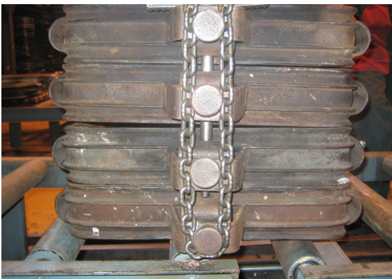
Kuva 326. Kehä käännetty ja valmiina kuljetukseen, huom! kaikki kehäkorvat ovat nyt ketjujen sisällä
