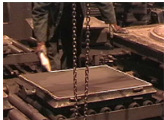
Kuva 341. Muotin jakopinnan tiivistäminen liimalla
