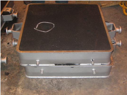
Kuva 350. Muotti kasattu puoliskot ristissä
