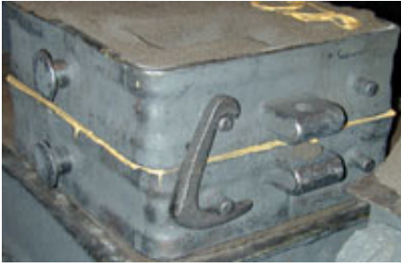
Kuva 342. Muotinpuoliskon välissä pursuaa tiivistysliimaa
