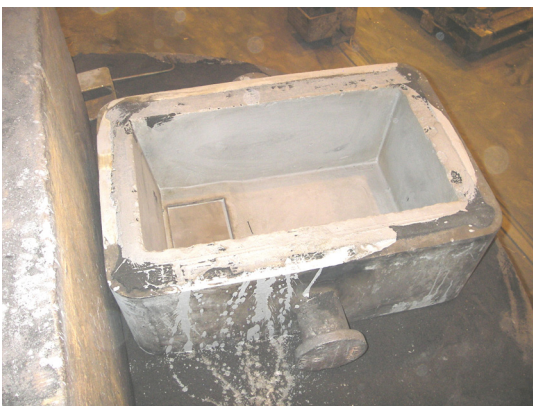
Kuva 333. Kaatoallas eli kuusa liitetty muottiin kokoonpanossa
