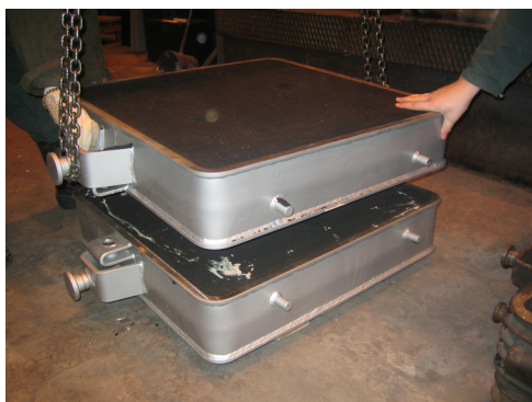
Kuva 356. Muotin kokoonpanossa ei näe kunnolla jakotasolle ja ohjaustupeja
