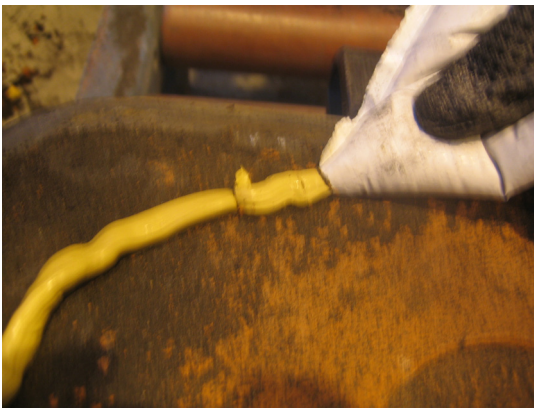
Kuva 335. Liima levitetään muovituubista kuusan ja muotin väliselle jakopinnalle
