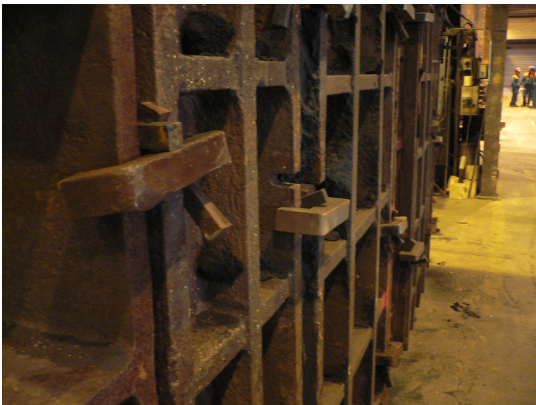
Kuva 364. Muotti suljettu rampulla ja kiiloilla
