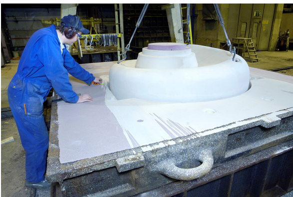
Kuva 300. Keerna laskettu muottiin kolmihaaraisilla nostoketjuilla
