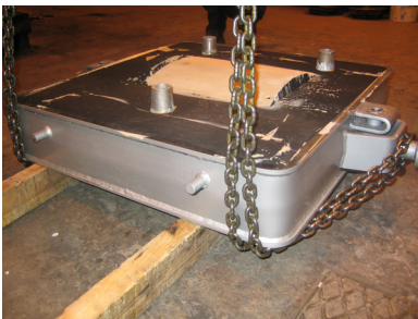
Kuva 321. Kehän kulman takaa ketjut päälle
