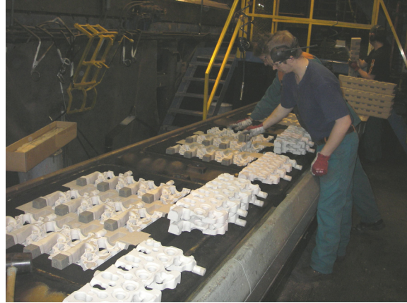
Kuva 296. Keernapaketteja valmiina muottiin asettavana
