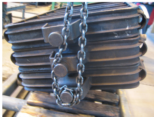
Kuva 328. Nosto alkanut, kehä kääntyy
