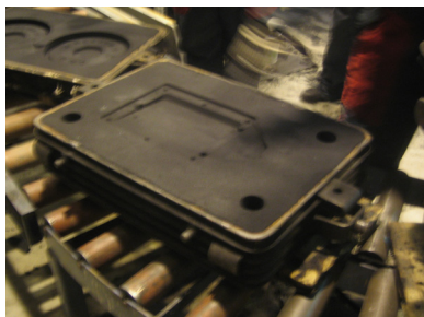
Kuva 354. Muotissa ohjaustupin sija
