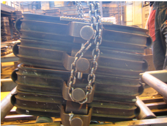
Kuva 324. Kehää lähdetään nostamaan
