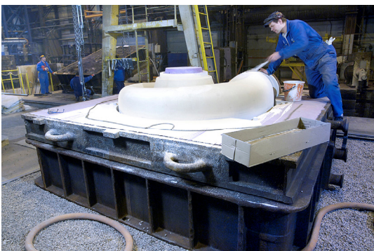
Kuva 337. Asetetaan tiivistenuuha jakopinnalle (huomioi tiivistenuuhan muodot)
