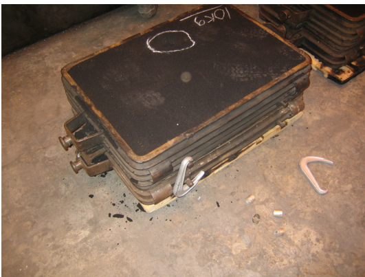
Kuva 362. Ramputus aloitetaan vastakkaisista kulmista
