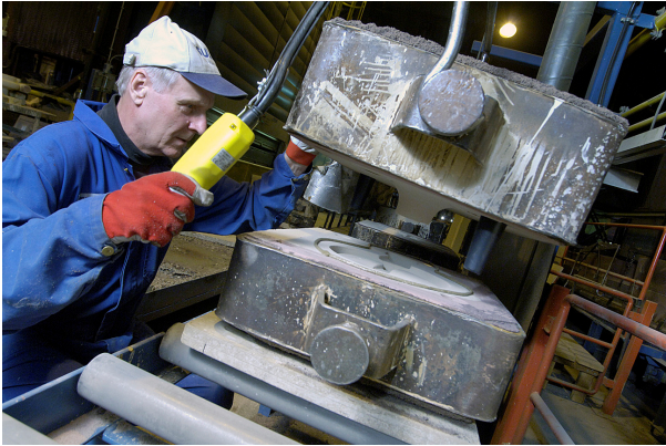
Kuva 357. Muotin kokoonpanossa nähdään hyvin muottionteloon
