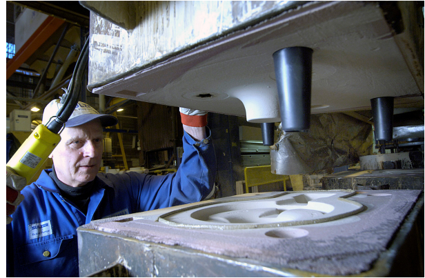
Kuva 358. Ohjaustupien ohjaaminen hallittavissa
