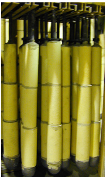
Kuva 372. Teräsvalussa käytettyjä sulkimia (kuusan stoppari samantyyppinen)
