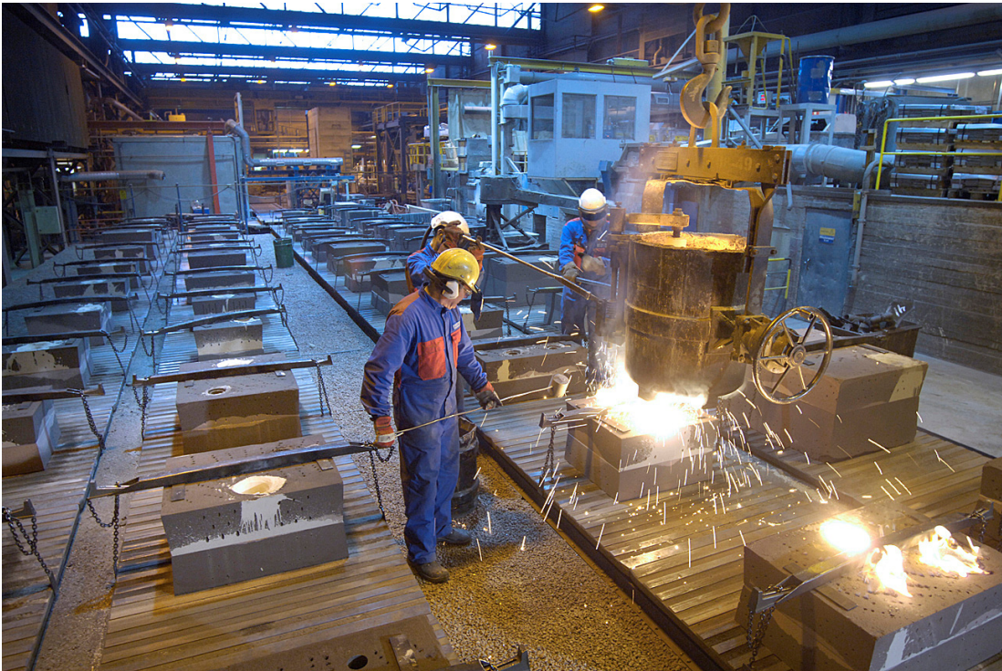
Kuva 378. Valuradalla valetaan pullamuotteja
