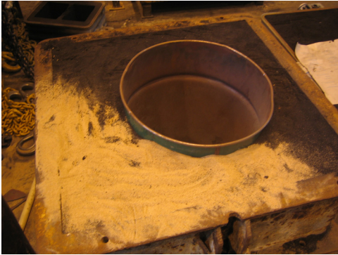
Kuva 450. Tyhjästä tynnyristä muottiin kaavattu hätäastia
