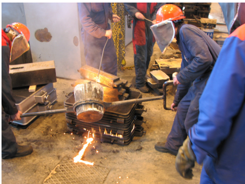
Kuva 449. Pieni muotti vuotaa valussa
