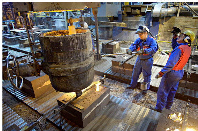
Kuva 427. Stoppari avattu teräsvalussa senkan pohjasta valuna
