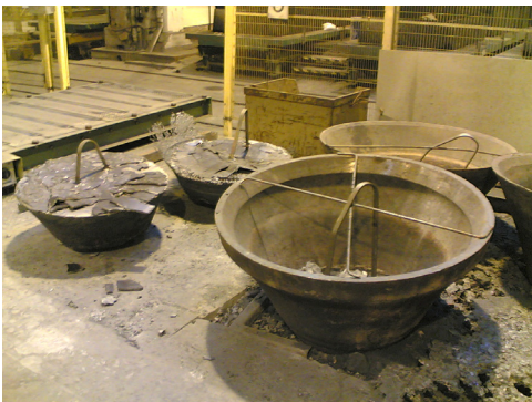
Kuva 451. Jäännössula-astiat eli tippakupit sekä jäähtyneitä sulajäännöksiä
