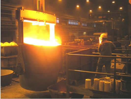
Kuva 408. Valuraudan kuonan poisto eli kummaus, senkka paikalle nosturissa
