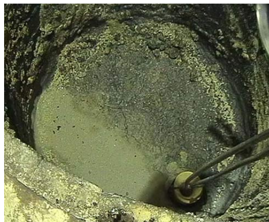
Kuva 397. Suutiiltä asennetaan senkkaan
