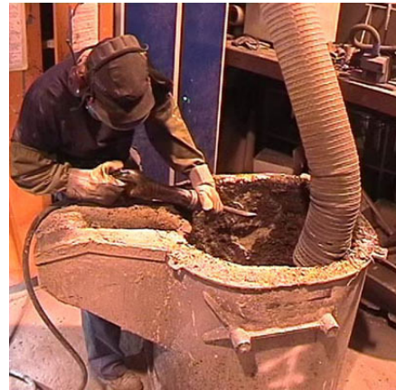
Kuva 390. Valurautasenkan pinnan huolto
