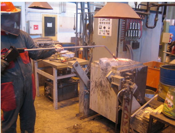
Kuva 409. Lämpötila mitataan uppopyrometrillä sulatusuunista
