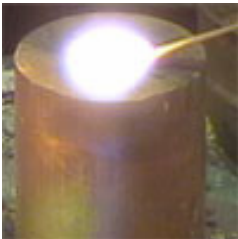
Kuva 434. Sula kaadetaan kokilliin
