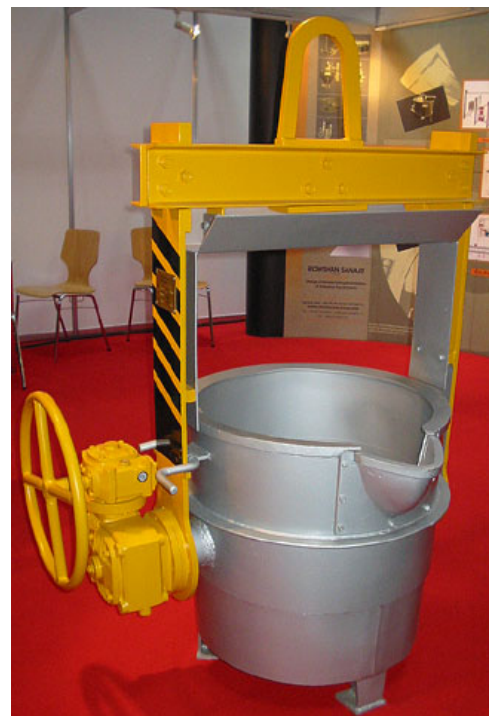
Kuva 385. Valurautasenkka nostovälineessään ilman vuorausta
