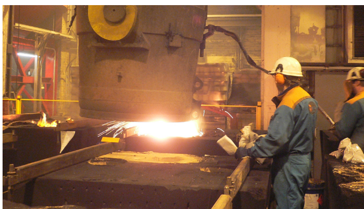
Kuva 431. Valmiina lisäämään lämpöä eristävää pulveria
