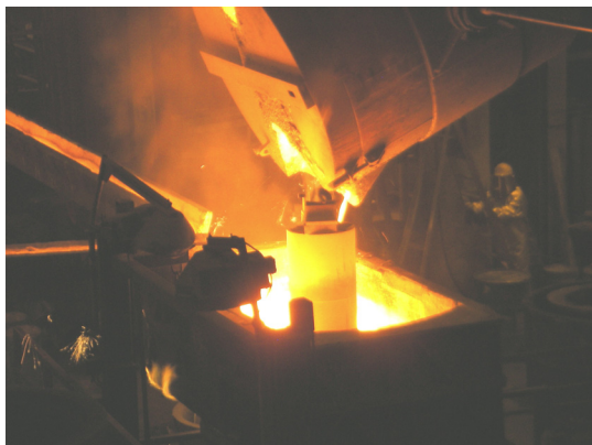
Kuva 428. Valutapahtuma käynnissä kuusaan, jossa kuulasuljin (stoppari) järjestelmäkäytössä
