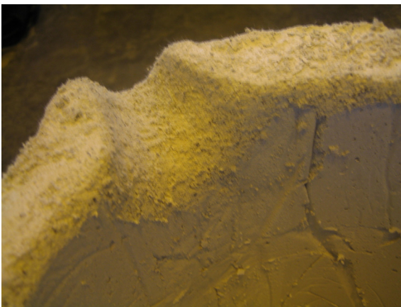
Kuva 391. Senkan kaatonokka oltava kunnossa ja oikean muotoinen oikean kaadon aikaansaamiseksi
