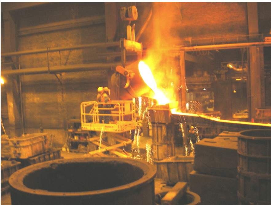
Kuva 380. Valu valukourun eli rännin avulla
