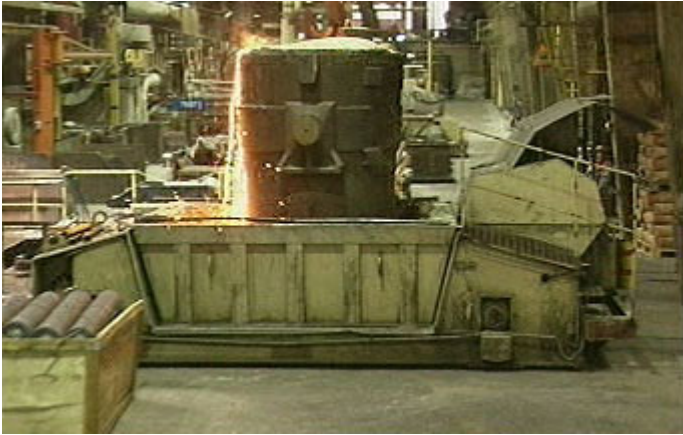
Kuva 422. Teräs kuljetetaan valupaikalle kuljetusvaunulla.
