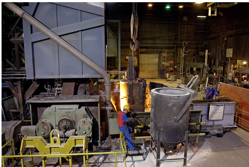
Kuva 398. Senkka tuodaan kaatoa varten sulatusuunille (konverterti)
