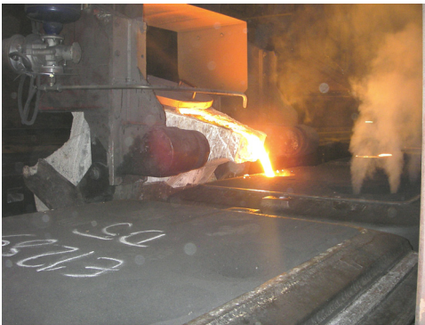
Kuva 445. Muottikaasuja nousee muotista valutapahtumassa
