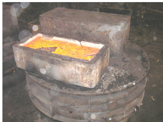
Kuva 430. Valukuusa täynnä valun jälkeen
