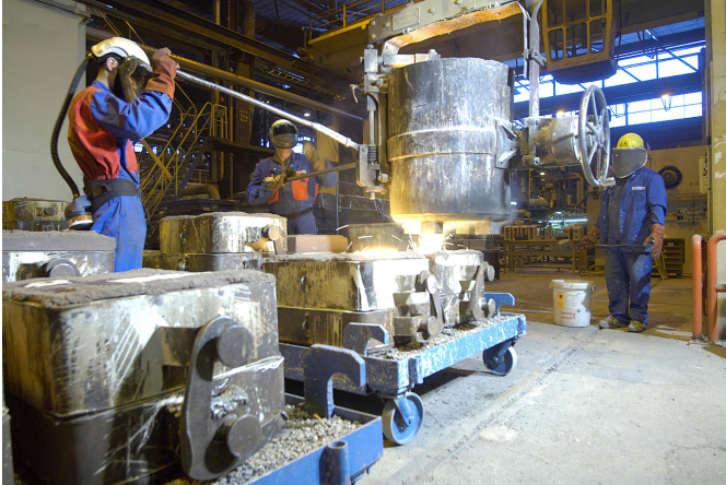
Kuva 381. Valu lattiatasolla, muotit vaunulla
