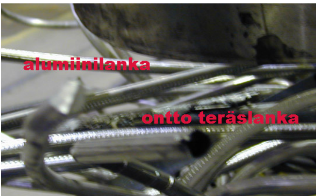
Kuva 421. Alumiinista ja teräsinjektointilankaa
