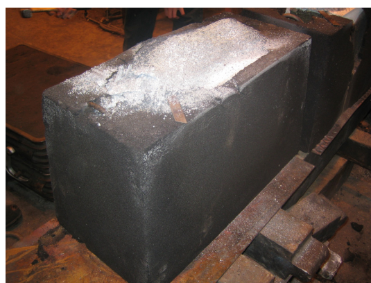
Kuva 432. Lämpöä eristävä aine lisättynä valun jälkeen
