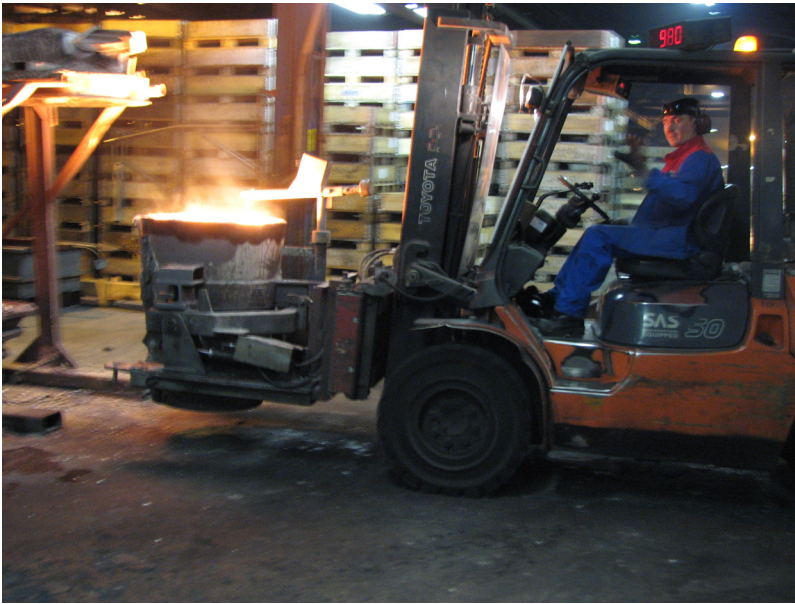
Kuva 400. Sula kuljetetaan trukilla käsittelyasemalle ja valukoneelle automaattikaavauksessa
