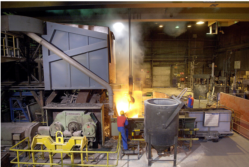
Kuva 399. Sulaa kaadetaan senkkaan
