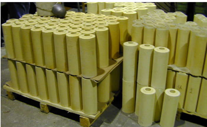
Kuva 393. Stopparin tekoon tarvittavia tiiliä
