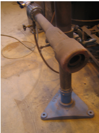
Kuva 387. Esimerkki pienestä senkan kaasulämmityslaitteesta
