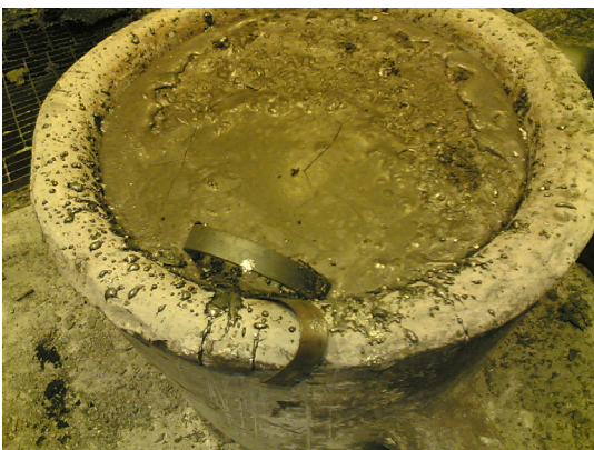
Kuva 452. Sula valettu tippakuppiin, jossa aineen tunnistustietopanta
