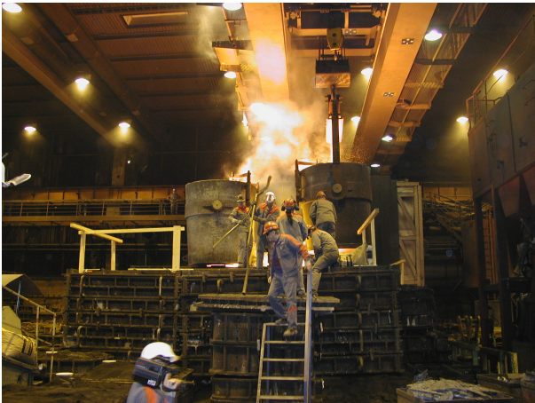
Kuva 382. Valuun valmistaudutaan kahdella senkalla
