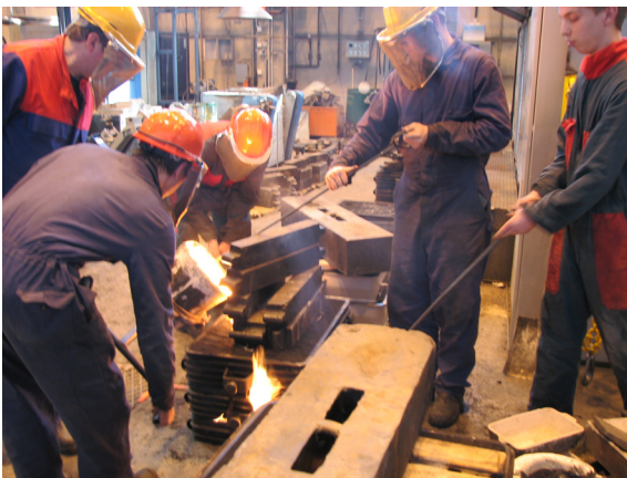
Kuva 447. Kaasu sytytään valun käynnistyessä pienessä muotissa
