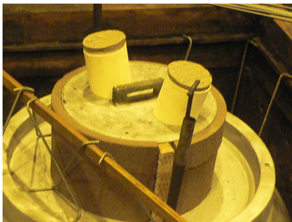
Kuva 463. Syöttökuppuun valetaan tiiliputken avulla nostoketjuja varten nostokorva
