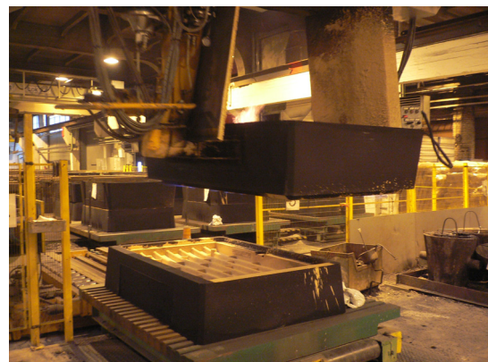
Kuva 482. Peitostuksen jälkeen muotti
