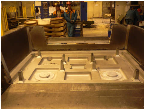
Kuva 477. Pullakaavausmallissa ja kehässä aukko muotin käsittelylaitteen tartuntaa varten
