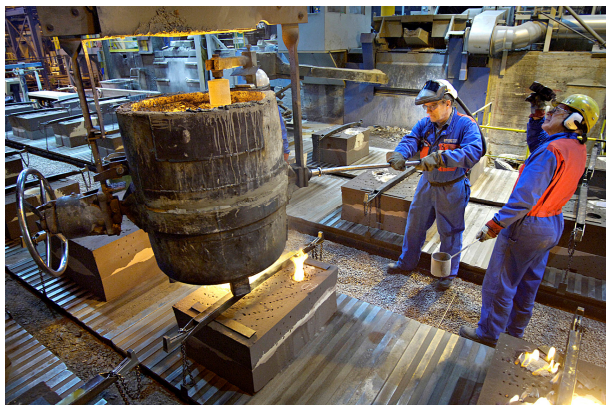
Kuva 483. Sitomalla suljettu muotti valun aloituksessa
