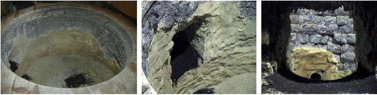
Kuva. Konvertterin vuoraus uunin sisällä
