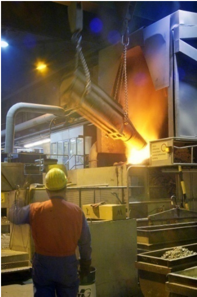
Kuva. Panostus sulatuksen aikana Kuva. Uunin panostusta korista kaatamalla
