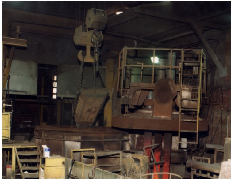
Kuva. Panostus sulatuksen aikana Kuva. Uunin panostusta korista kaatamalla
