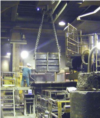
Kuva. Uunin holvi käännetty sivulle panostusta varten
