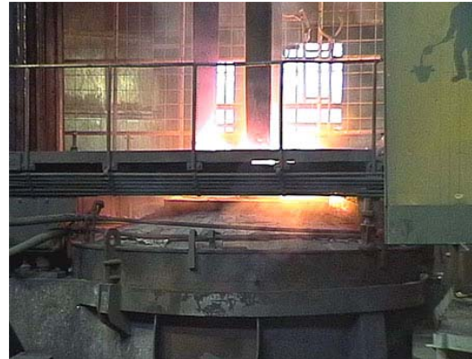
Kuva. Sulatustapahtuma (elektrodit kohtisuorassa kannen läpi)
