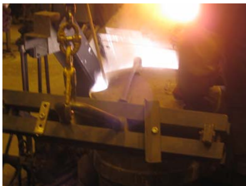
Kuva. Mg- reaktio käynnissä, senkka suljettu kannella
