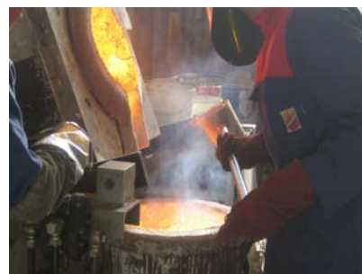
Kuva. FeSiMg lisätään kaatosuihkuun
