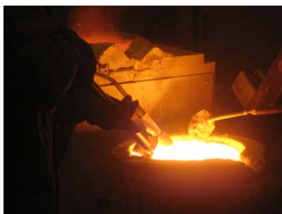
Kuva . Valulämpötilan mittaus kuonattaessa
