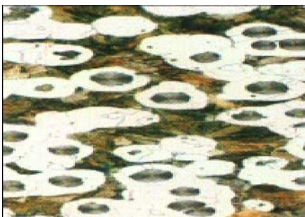
Kuva. Ferriittinen rakenne
