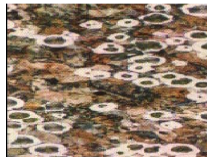
Kuva. Perliittinen rakenne pallon ympärillä hieman grafiittia
