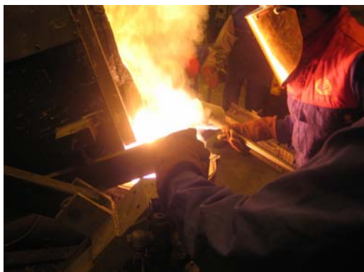
Kuva. Mg lisätään kaatosuihkuun
