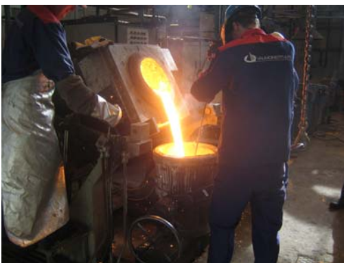
Kuva. Ympäysainetta suojataan upottimella
