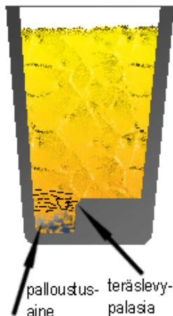
Kuva. Sandwich- menetelmä
