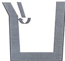
Kuva. Kuonanerotin senkan nokassa
