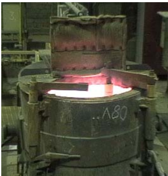
Kuva. Senkkaa lämmitetään maakaasulla
