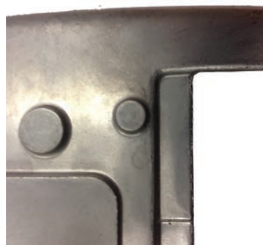
Painevalun pinnanlaatu. Kestomuoteilla päästää pinnanlaatuun 20 - 120 RMS
