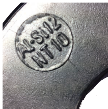
Kokillivalun pinnanlaatu. Kestomuoteilla päästää pinnanlaatuun 20 - 120 RMS
